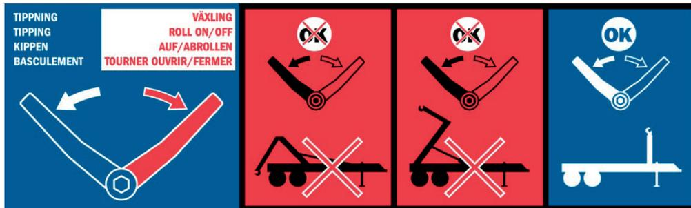
**HINWEIS!** Das Auf-/Absetzen der Auf-/Absetzeinheit ist nur zulässig, wenn sich der Rahmen in der gesicherten Position befindet.
