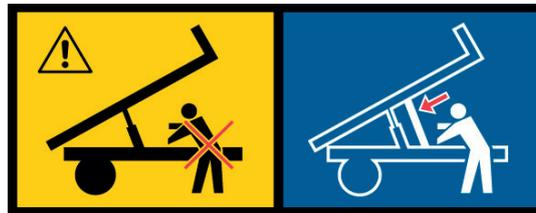
*Verwendung der Sicherheitsstütze*
