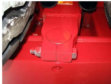
Boulons des deux côtés du bogie
