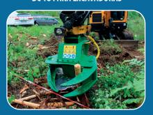
FARMA también ofrece la cabeza de tala BC 18 para excavadoras. Permite talar, recoger, cortar y cargar fácilmente árboles, arbustos, maleza, matorrales, tocones, etc. Los árboles se cortan fácilmente y el mantenimiento de la hoja fija es muy sencillo. La posición del centro de gravedad hace muy fácil colocar la grapa directamente junto a la raíz. Este producto puede considerarse como una combinación de grapa y cabeza de tala.
